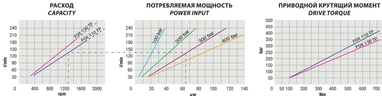
ИСПЫТАНО С ЖИДКОСТЬЮ ПО ISO VG 46 ПРИ  $\Delta T$  50°C ( $\nu = 30$  cSt)
