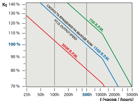
Коробки отбора мощности рассчитаны на гарантированный рабочий жизненный цикл в 500 часов при 1500 об/мин и максимальном крутящем моменте. На диаграмме рассчитан жизненный цикл КОМ при других параметрах работы.
