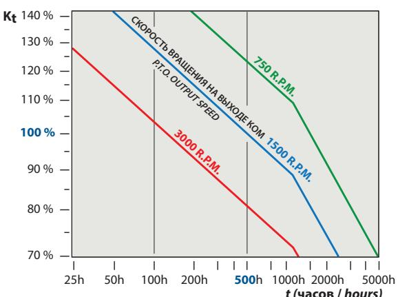
Коробки отбора мощности рассчитаны на гарантированный рабочий жизненный цикл в 500 часов при 1500 об/мин и максимальном крутящем моменте. На диаграмме расчитан жизненный цикл КОМ при других параметрах работы.
