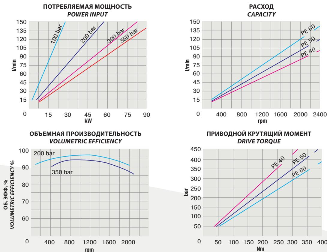
ИСПЫТАНО С ЖИДКОСТЬЮ ПО ISO VG 46 ПРИ ΔT 50°C (ν = 30 cSt)
